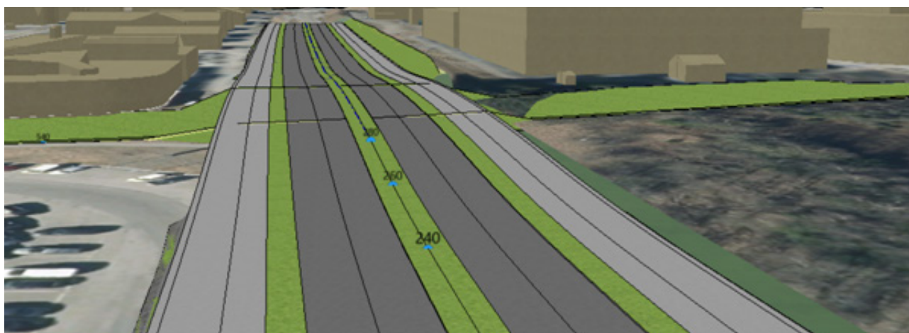
Figur 2.6.8 - Modellutsnitt av Fv. 174 som heves over kryssingspunkt.
