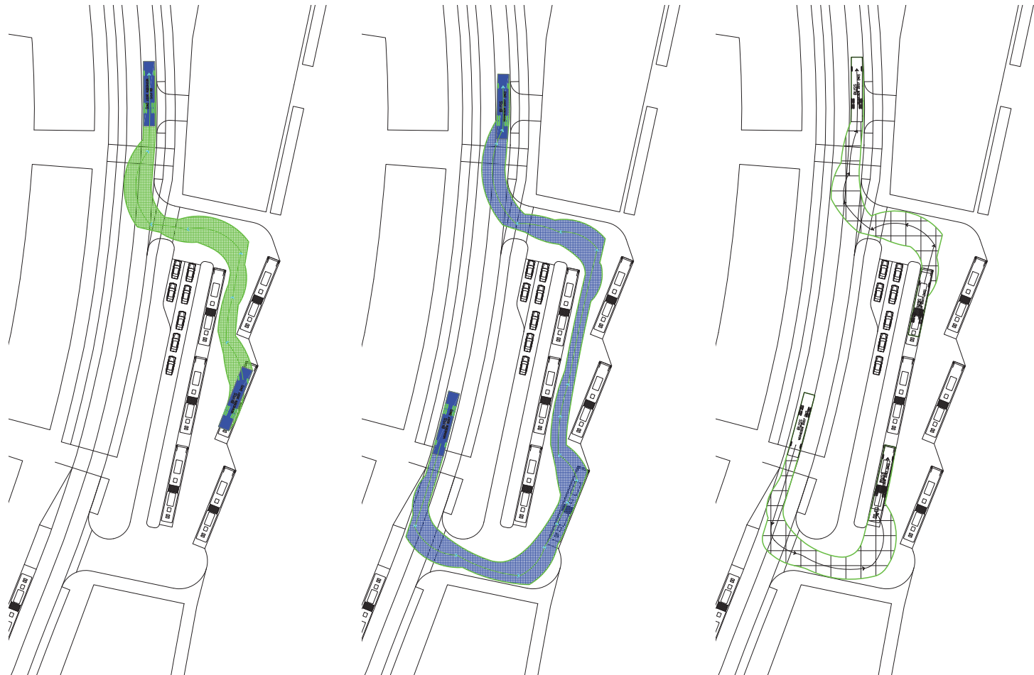
Illustrasjonene viser leddbusser, sporingskurvene er for bogie-buss
